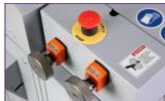
Diales de rodillos de recubrimiento para un solo ajuste
